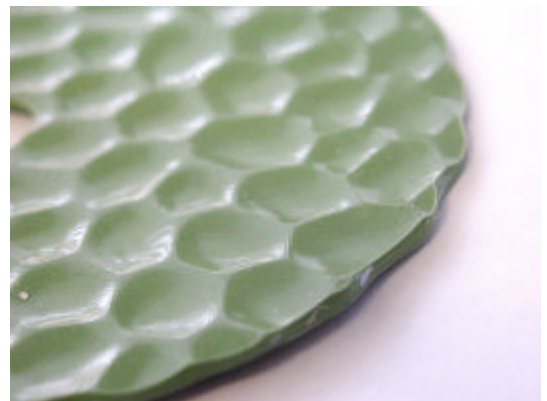
Bild 6: Detail: Negativabdruck der spezielle Masse zur Wiederherstellung der Struktur
