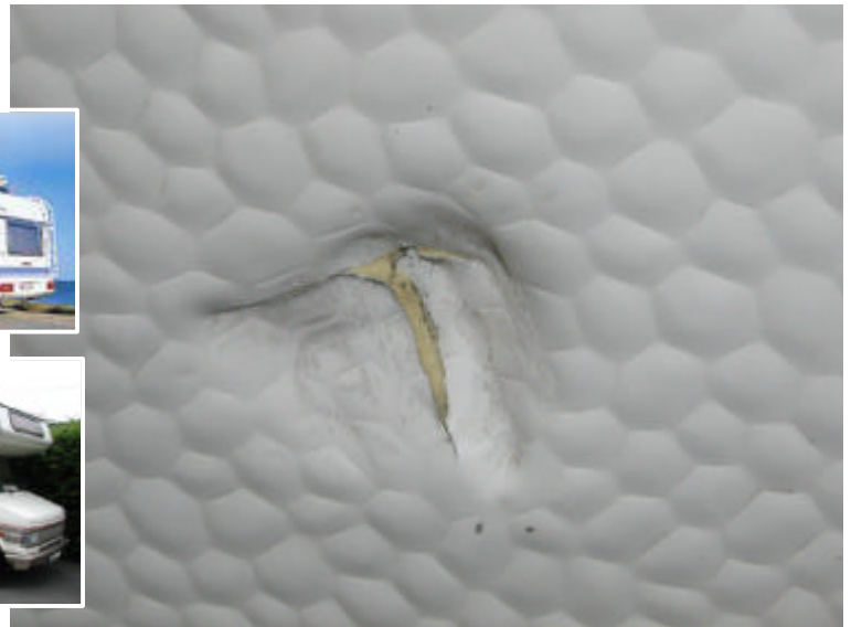
Detail: Wohnwagen mit Delle und Riss in der Seitenbeplankung
